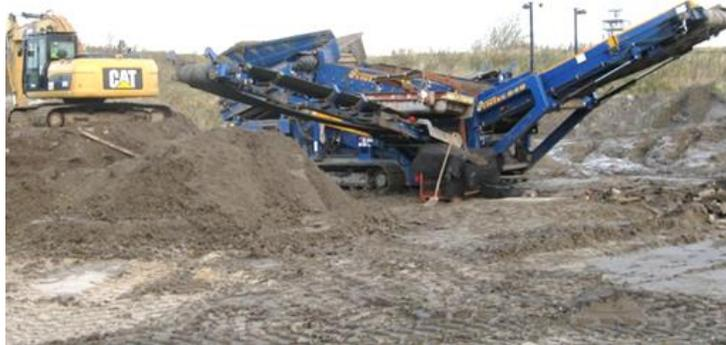
**Siebanlage zur Bodenaufbereitung**
